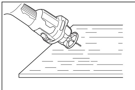
Lleve con cuidado la herramienta a la posición recta de forma que la base de la zapata haga contacto con el material completamente.
