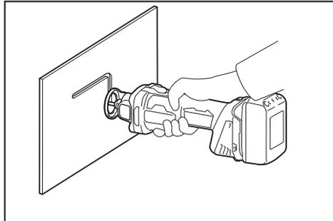
Cuando utilice la fresa guía para tabla-roca en tabla-roca, inserte la fresa con cuidado en línea recta hasta que la base de la zapata haga contacto con el material completamente. Mueva la herramienta despacio con una presión constante en dirección hacia la derecha para hacer un corte.
